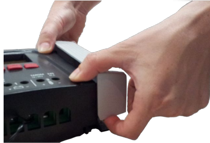
Abb. 3: Abdeckung aus der Endstellung lösen (hier: rechte Abdeckung)
